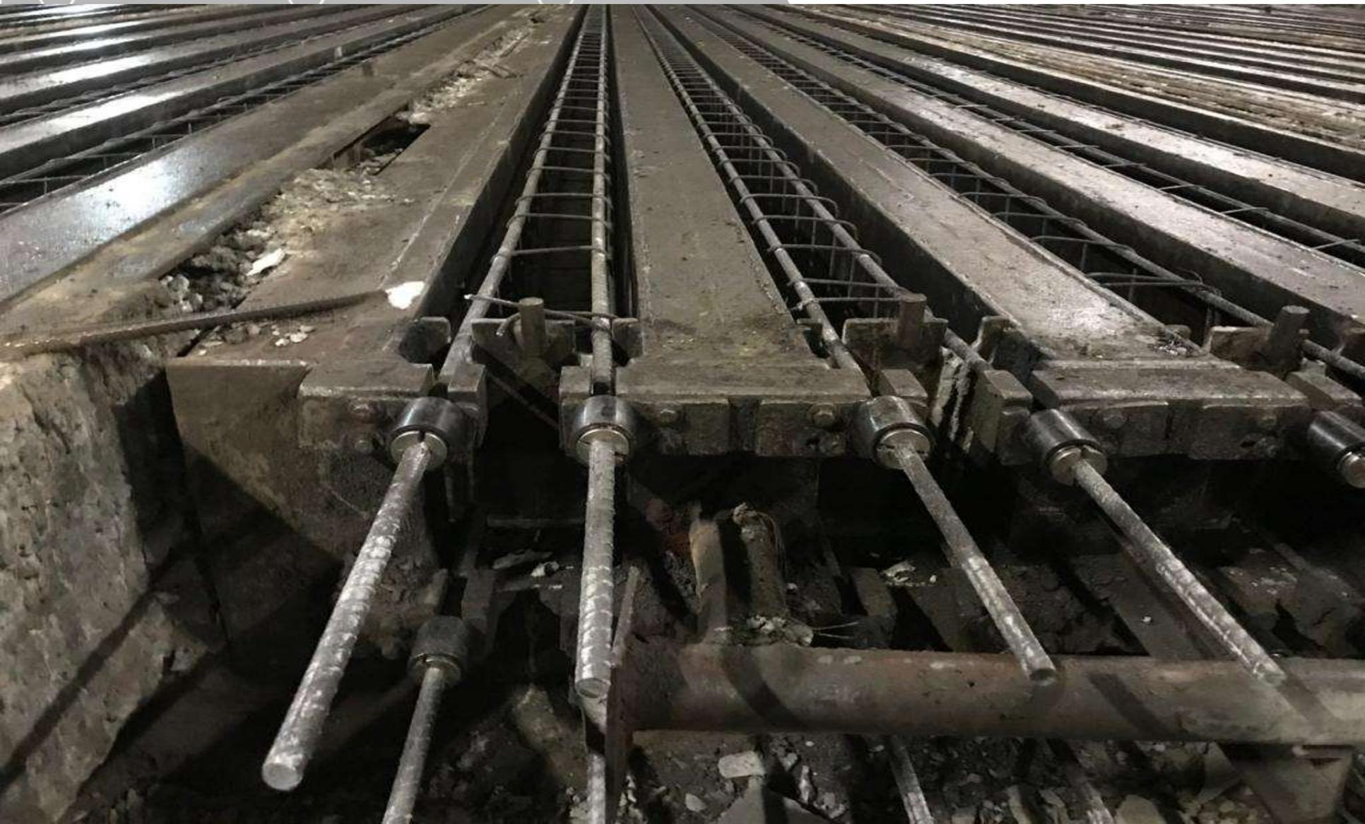
Предварительное напряжение композитной арматуры торговой марки BASIS при изготовлении электрической железобетонной стойки СВ с использованием конусной композитной пружины (540-600 Мпа – 0,45-0,5 нагрузки)
