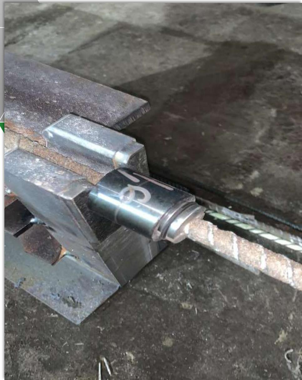
Предварительное напряжение композитной арматуры
