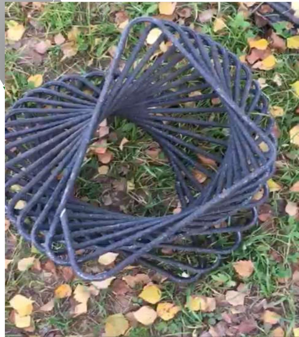
Композитные элементы для каркасов
