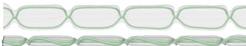
Рисунок 3. – Профиль стеклопластиковой арматуры прямоугольного вида
